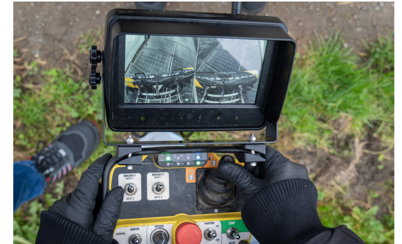
Nessun lavoro in altezza: controllo a distanza da terra
